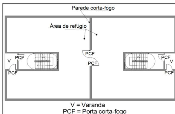
**Figura 17** - Desenho esquemático da área de refúgio
