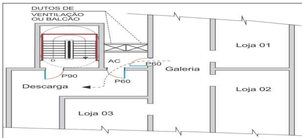
Figura 20 - Acesso de galeria comercial à descarga
