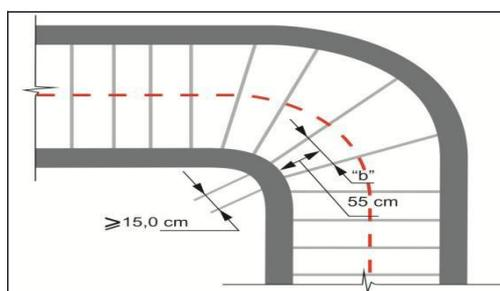
Figura 5 - Escada com lanços curvos e degraus balanceados
