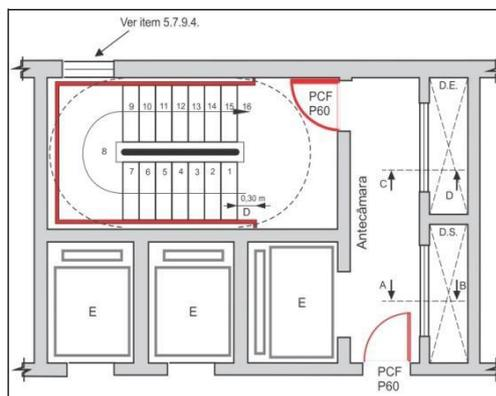
Figura 9 - Escada enclausurada à prova de fumaça
