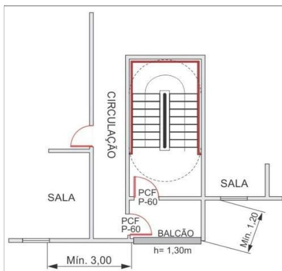
**Figura 11** - Escada enclausurada do tipo PF ventilada por balcão
