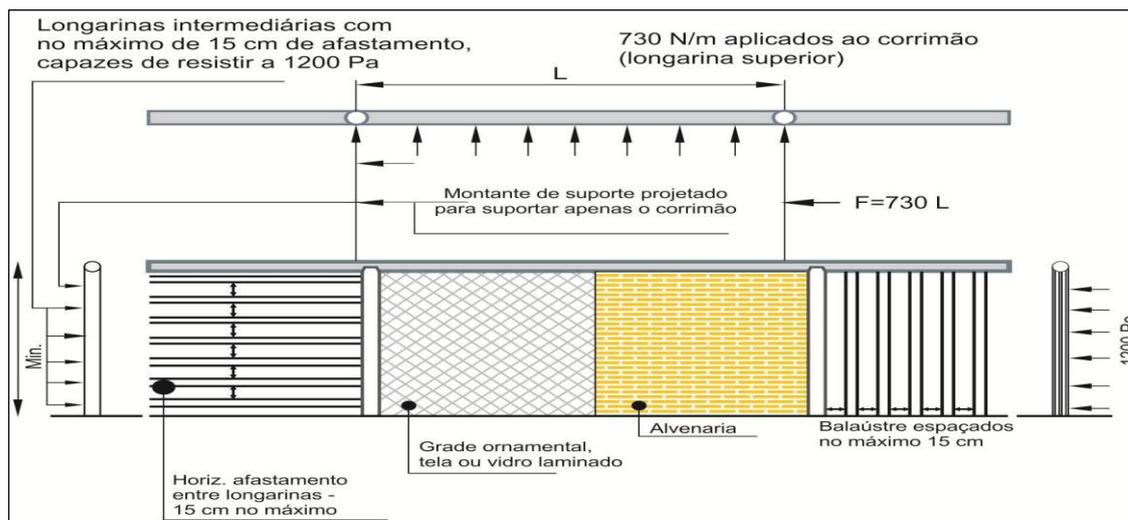
Figura 16 - Pormenores construtivos da instalação de guardas e as cargas a que elas devem resistir
