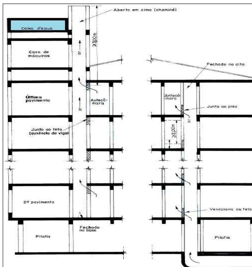
Figura 10 - Exemplo de dutos de ventilação (corte AB e corte CD)
