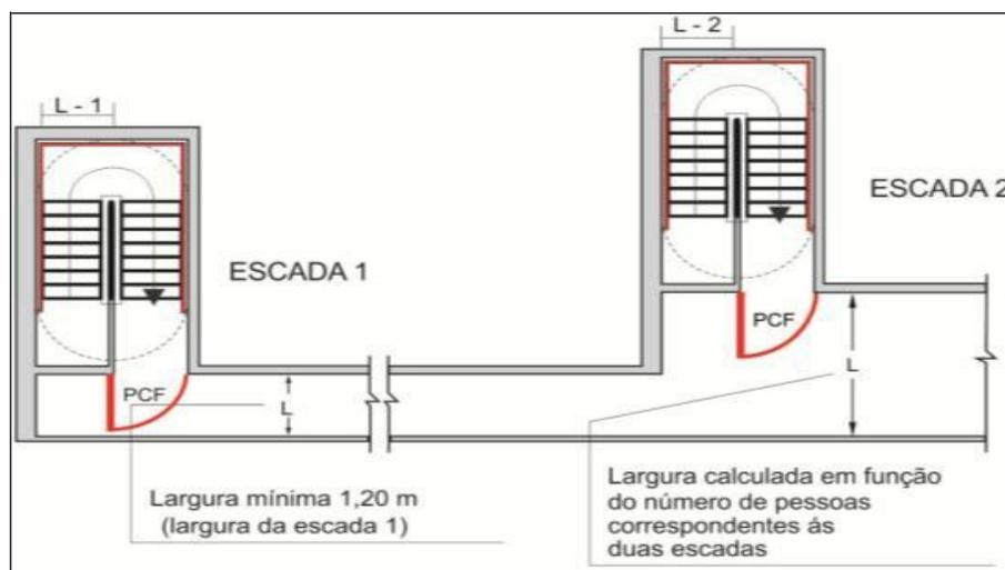
Figura 19 - Dimensionamento de corredores de descarga
