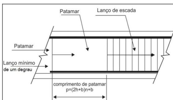
**Figura 6** - lanço mínimo e comprimento de patamar
